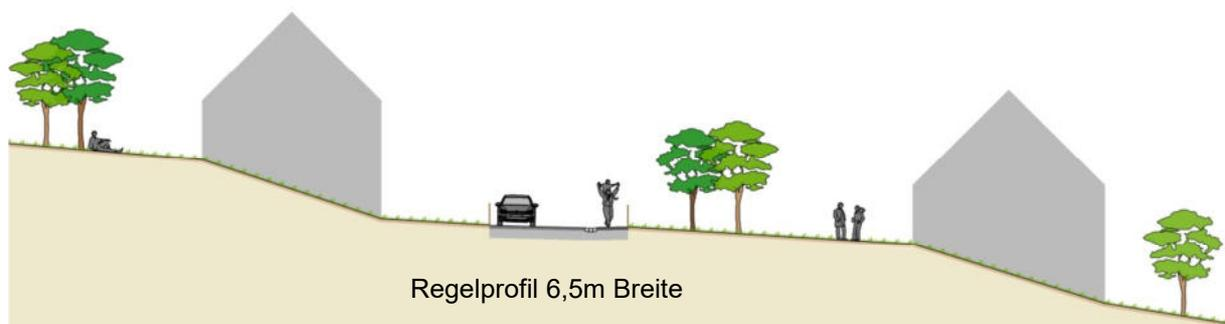
Abb. 22a: Schnitt durch Hangbebauung mit Erschließungsstraße, Teilbereich ‚Oberer Hang‘
