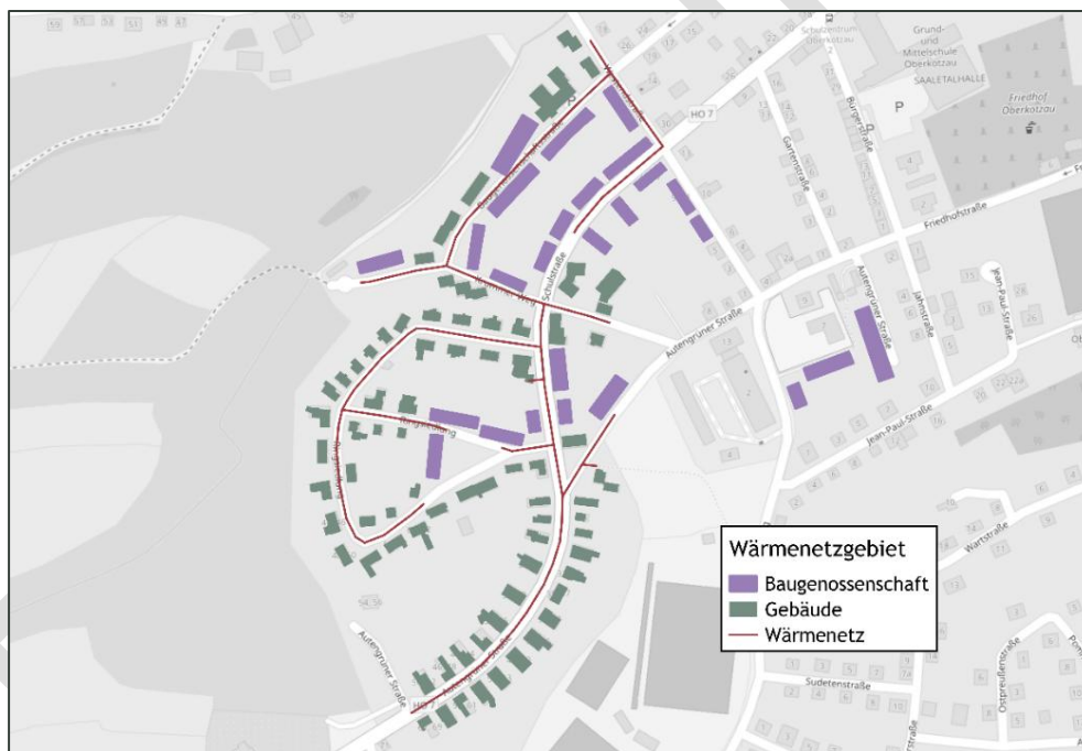
Abbildung 52: Mögliches Wärmenetz im Fokusgebiet Baugenossenschaft, eigene Darstellung
